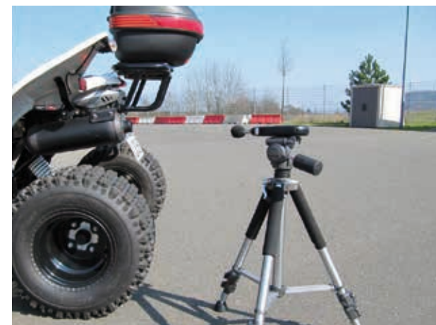
Geräuschemessung am Quad
